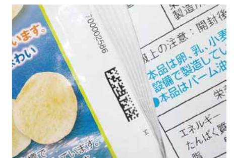
作業ミス防止照合システムで読み取るフィルムに記載されているコード
